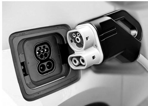
Bild 7 Lademöglichkeiten von Elektrofahrzeugen und "Fahrzeugkupplung einer Combo-2-Schnellladestation"
